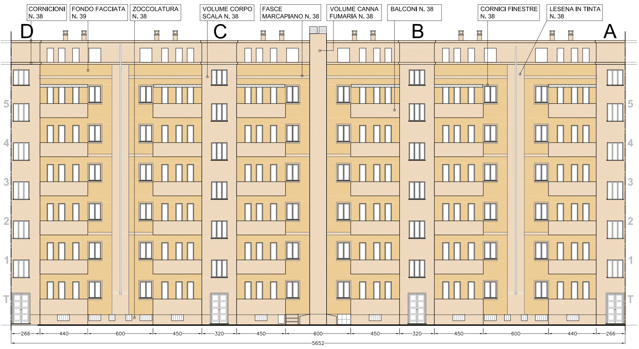
PROSPETTO FACCIATA LATO CORTILE - scala 1:200
